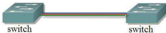
Figure 2.7 : Subdivision d'une liaison physique en liaison logique (Trunking)
